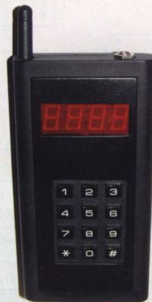
Obr. 4. Hotová zadávací jednotka
